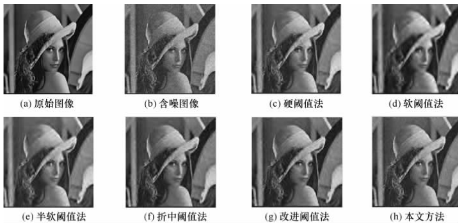
图 4 针对 Lena 图像的各种方法去噪结果对比
